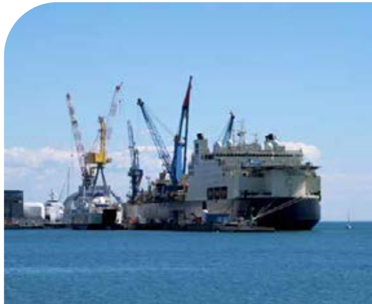
Ejemplo de un buque de tendido de tuberías
