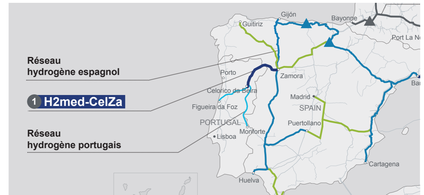
Le réseau espagnol de transport d'hydrogène prévoit deux axes principaux. Le premier englobe l'axe de la côte cantabrique, l'axe de la vallée de l'Èbre et l'axe du Levant. Le second englobe l'axe de la Vía de la Plata relié à la vallée de l'hydrogène de Puertollano.
